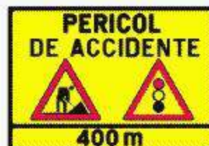
Presemnalizarea unui sector cu circulație alternantă
