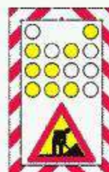
Semnalizarea unui utilaj care se deplasează lucrând
