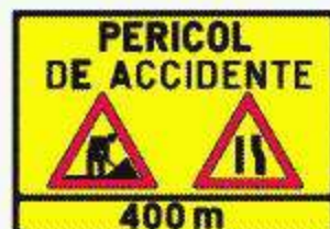
Presemnalizarea unui sector cu circulație alternantă
